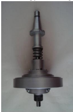
Рисунок 1 – Пристрій для розточування ущільнюючих циліндричних поясків під гільзи блоків циліндрів
