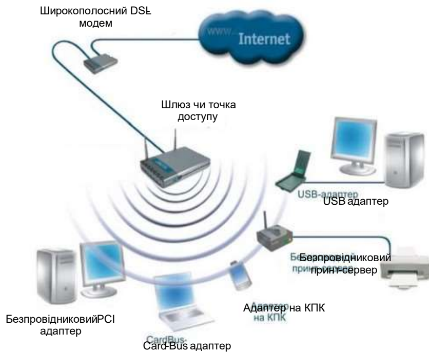
Рис. 5.6. Підключення мережевих пристроїв за стандартом Wi-Fi 802.11x
