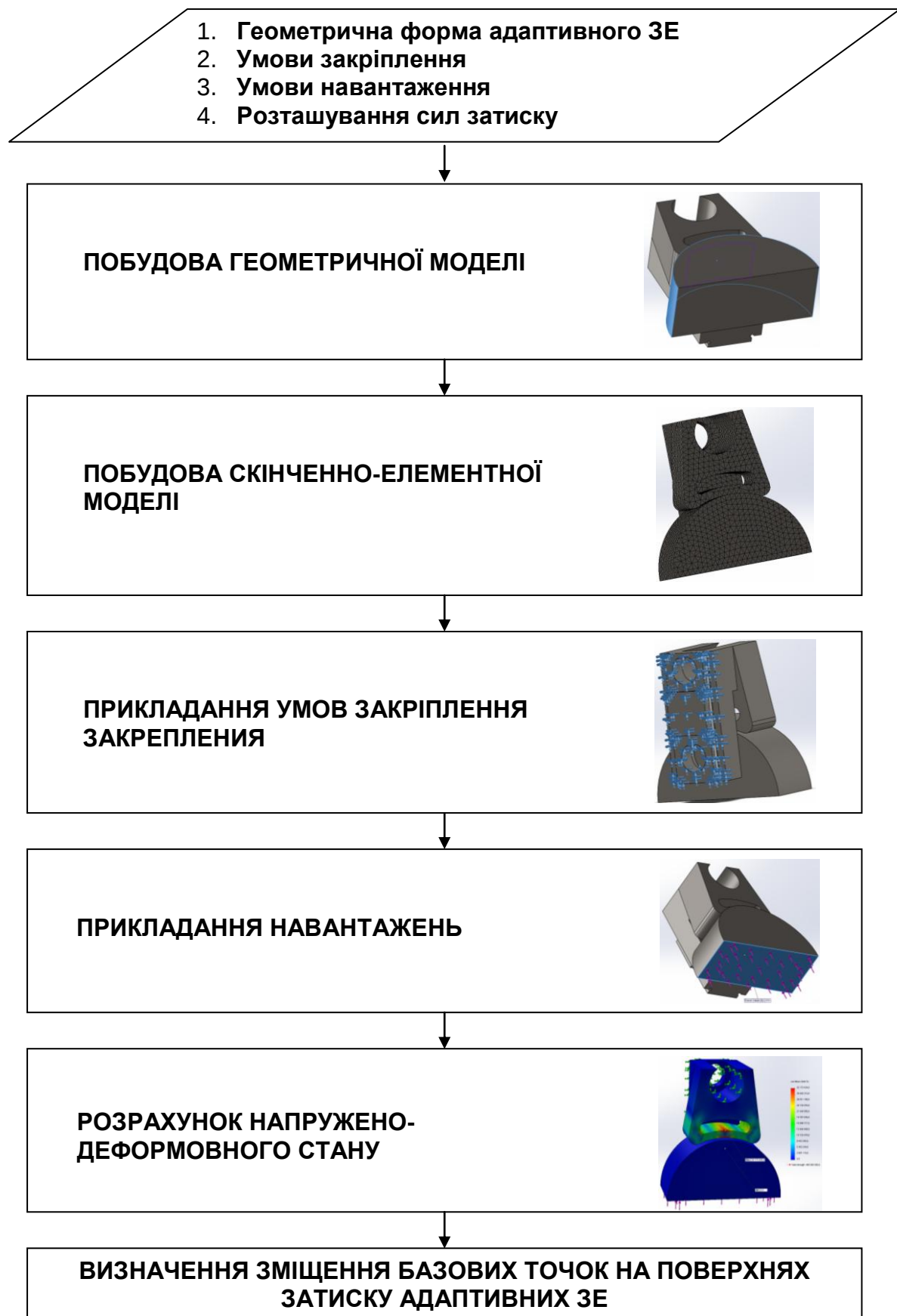
Рис. 3.1. Блок-схема методики розрахунку деформацій кільцевого сегменту зони затиску адаптивного затискного кулачка засобами твердотільного моделювання
