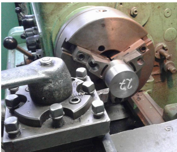
Рис. 5.1. Обробка деталі, затиснутої у адаптивних ЗЕ, на токарно-винторізному верстаті мод. 1К62
