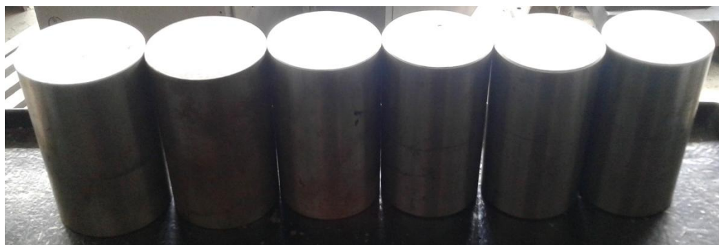
Рис. 3.12. Контрольні оправки для визначення радіального биття заготовок встановлених в адаптивні ЗЕ
