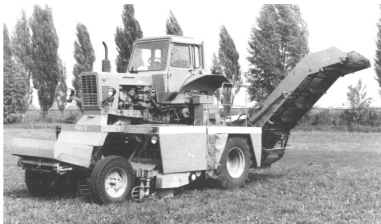
Рис. 4.5. Загальний вигляд удосконаленої коренезбиральної машини МКК-6
