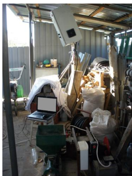
Рис. 3.7. Схема стенду для дослідження процесу транспортування сипких вантажів гвинтовим механічним та шнеково-пневматичним транспортером
