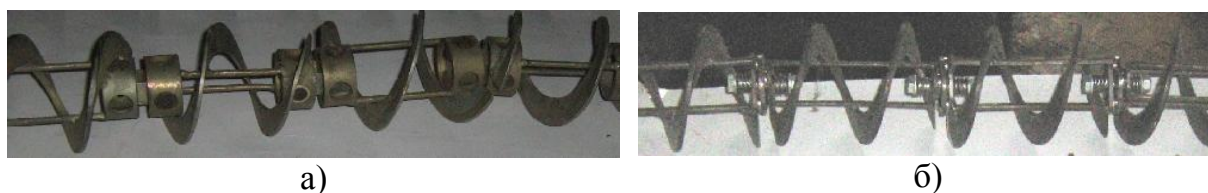
Рис. 3.10. Секційні ГРО з: а) шарнірним з'єднанням; б) запобіжним з'єднанням
