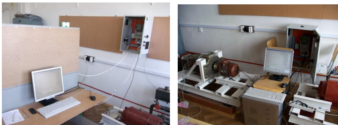
Рис. 3.1. Загальний вигляд автоматизованого електроприводу для дослідження механічних систем з перетворювачем частоти і персональним комп'ютером
