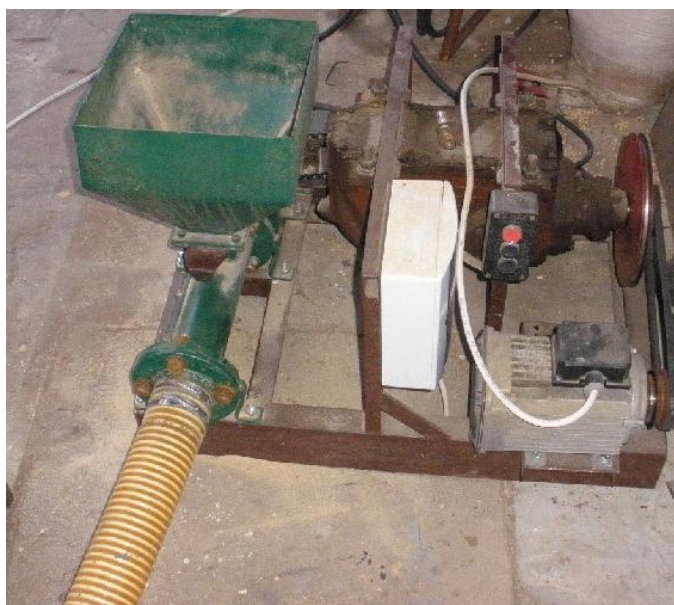
Рис. 3.7. Схема стенду для дослідження процесу транспортування сипких вантажів гвинтовим механічним та шнеково-пневматичним транспортером
