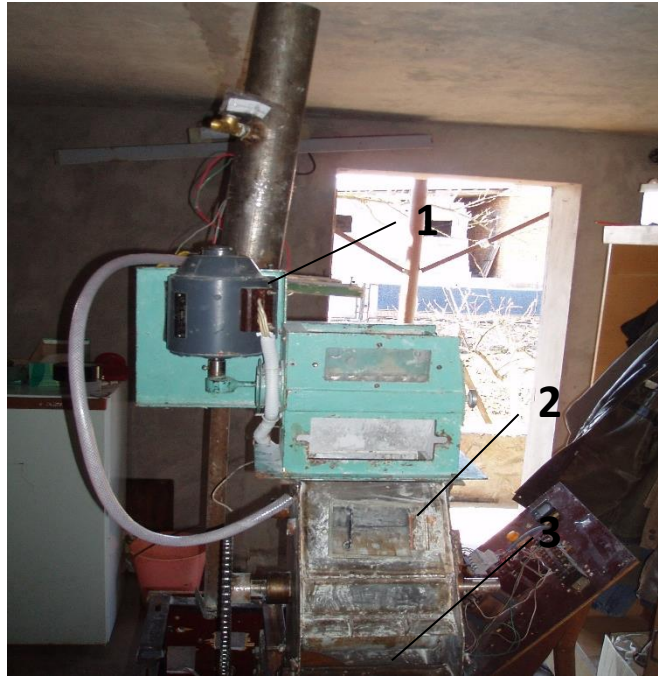
Рис. 2.2. Загальний вигляд ДБТМ: 1 – дозатор рідких компонентів; 2 – вібродозатор борошна; 3 – місильна машина
