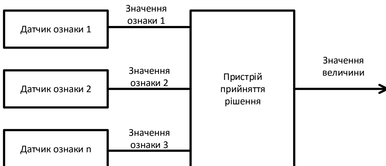
Рис. 3.7. Схема пристрою для одержання значень номінальних величин
