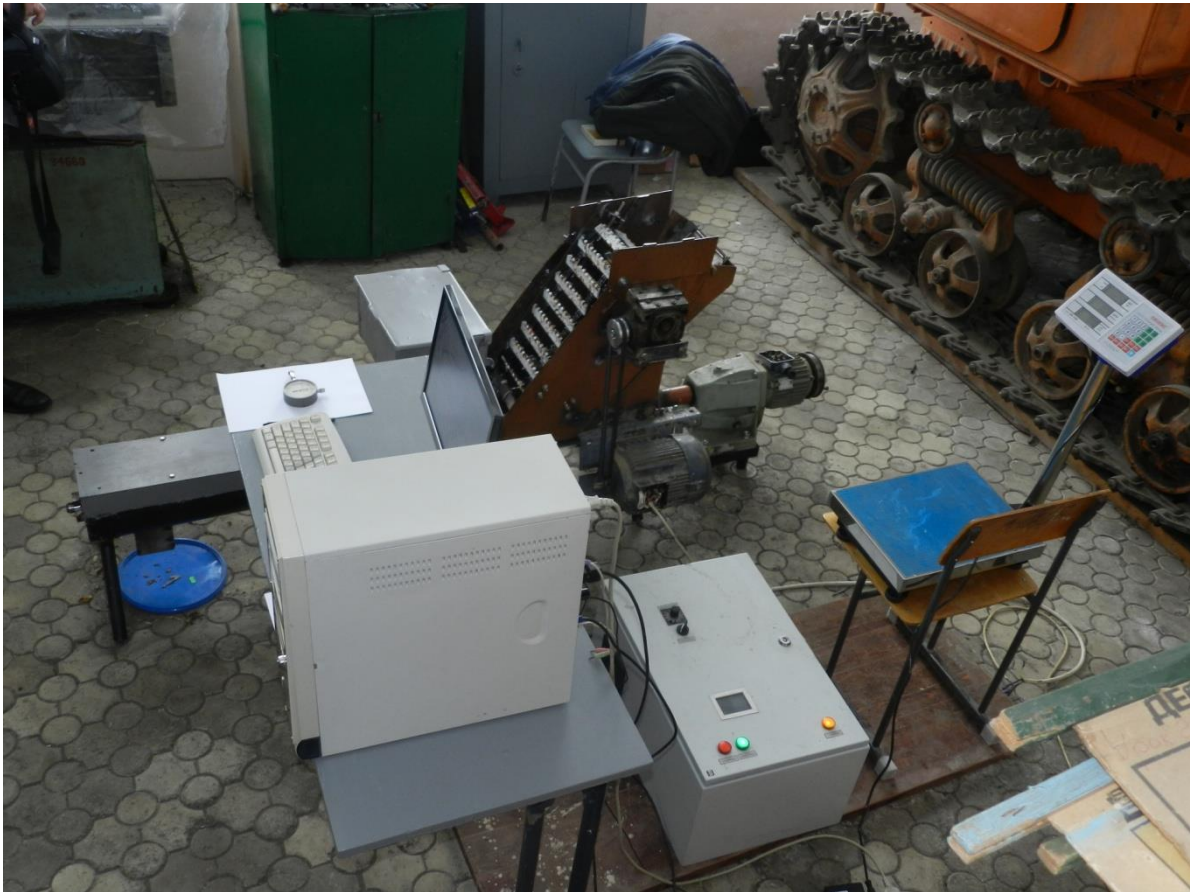
Рис.3.3. Загальний вигляд експериментальної установки та обладнання для дослідження експлуатаційних характеристик кормоподрібнювача змішувача
