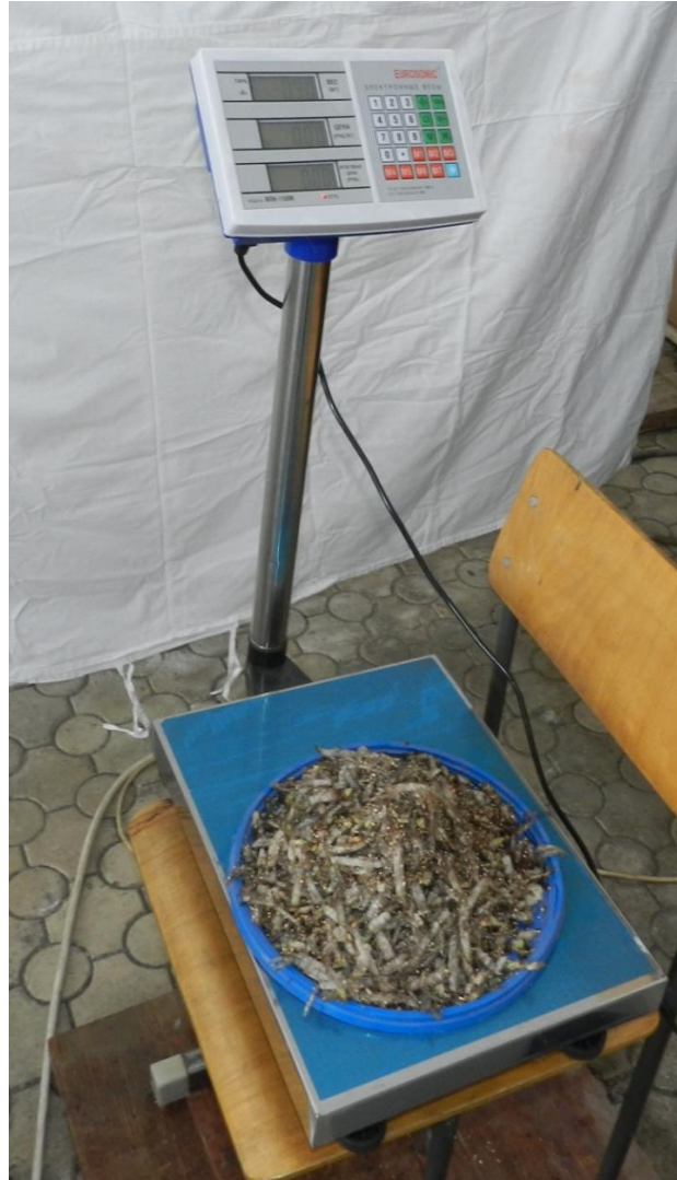
Рис. 3.5. Загальний вигляд електронної ваги для визначення продуктивності подрібнювача коренеплодів
