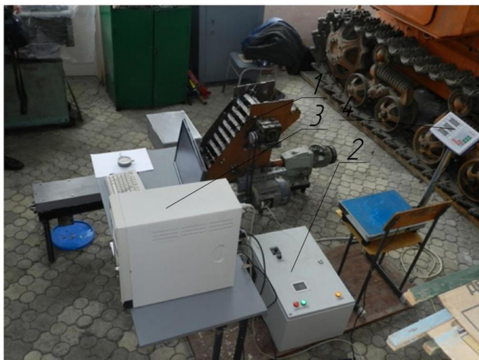
Рис.19. Загальний вигляд експериментальної установки: 1– подрібнювач коренеплодів; 2 – Altivar 7; 3 – комп'ютер; 4 – електронна вага
