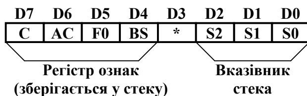
Рис. 48. Формат регістра слова стана процесора
