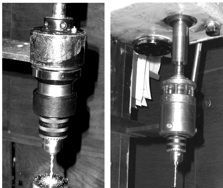
Рис.8. Запобіжні свердлильні патрони, виготовлені з використанням конструктивних елементів оправки
