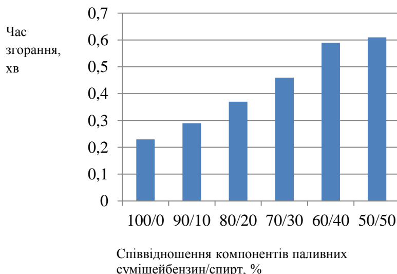
Рис.9. Залежність часу згорання бензиново-етанольної суміші (хв) в залежності від частки абсолютного етанолу
