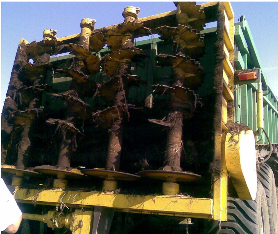
Рис. 1. Модернізована конструкція машини РТД-14 з удосконаленими бітерними розкидними робочими органами для поверхневого внесення органічних добрив
