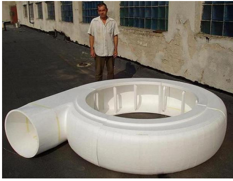
Рис. 6. Пінополістиролова модель відливки корпусу насоса для перекачування гірничої пульпи зі зносостійкої сталі
