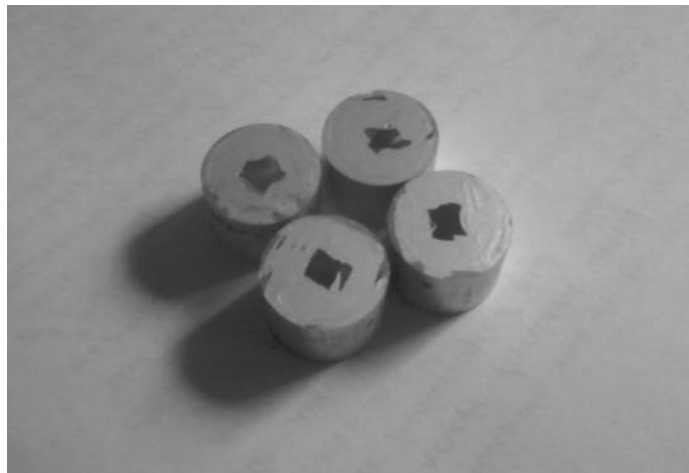
Рисунок 4.2 – Мікрошліфи для дослідження структури методами оптичної та електронної мікроскопії.
