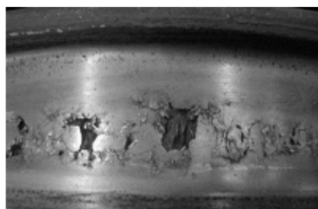
Рис. 22. Вищербини на поверхні кочення залізничних коліс.
