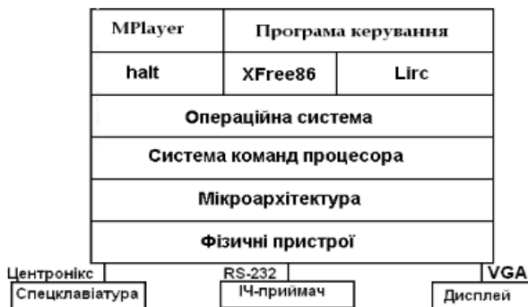
Рис. 4. Блок-схема програмної частини системи відображення
