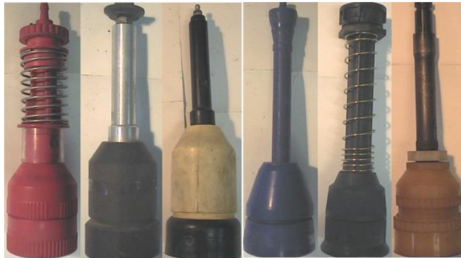
Рис. 1 Захватні пневмоелементи укладальників пляшок
