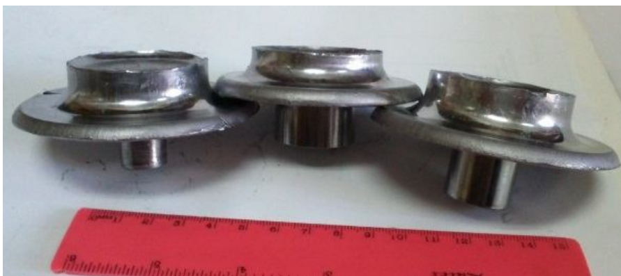
Рис. 1. Дослідні деталі, що отримані комбінованим видавлюванням
