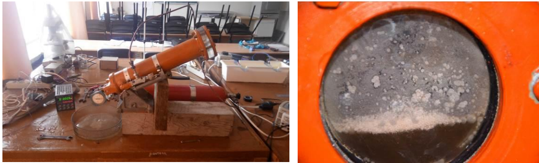
а б Рисунок 1. Установка для синтезу газогідратів (а), синтезований гідрат метану (б)
