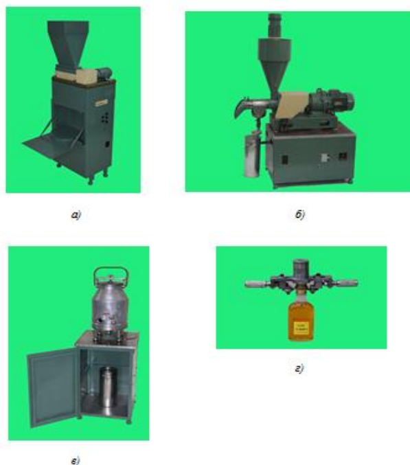
Рис. 2. Комплекс обладнання для отримання олії в переробних цехах сільськогосподарських під-приємств: а) плющик насіння; б) шнековий олійний прес; в) відстійник олії; г) ручний закупорювальний пристрій.
