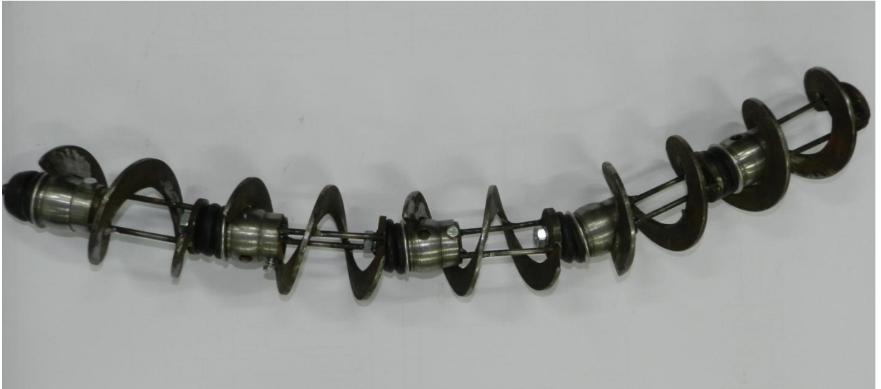
Рис. 3.4. Загальний вигляд експериментального секційно-шарнірного робочого органу гвинтового конвеєра
