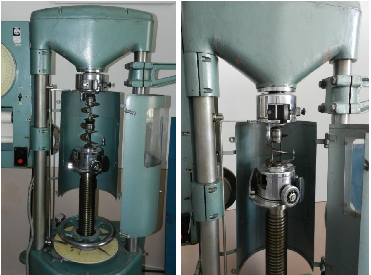
Рис. 3.15. Загальний вигляд машини на кручення КМ–50–1 з дослідними зразками секцій робочих органів
