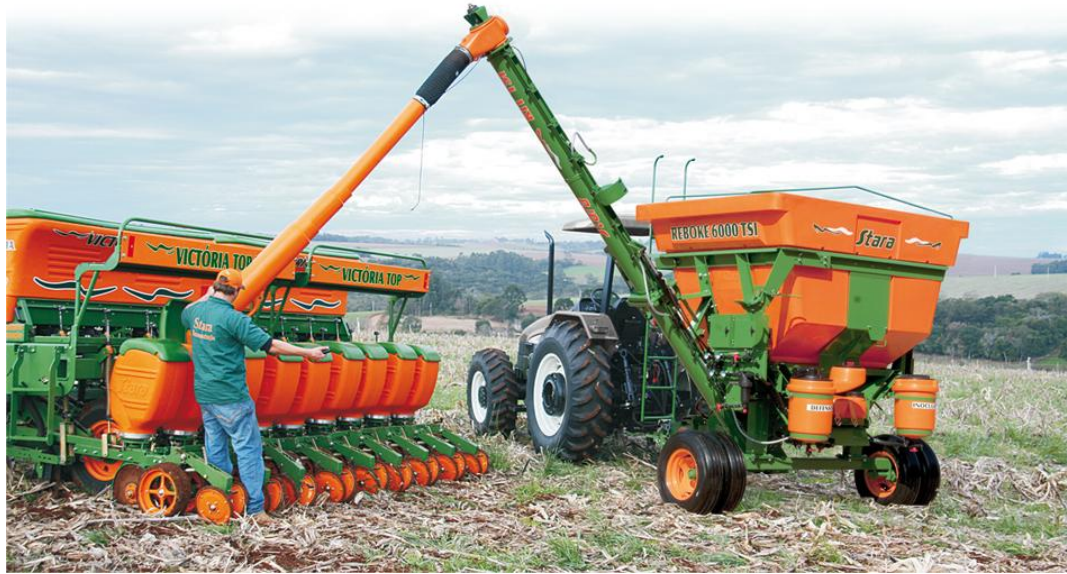
Рис. 1.3. Універсальний агрегат при завантаженні сівалки
