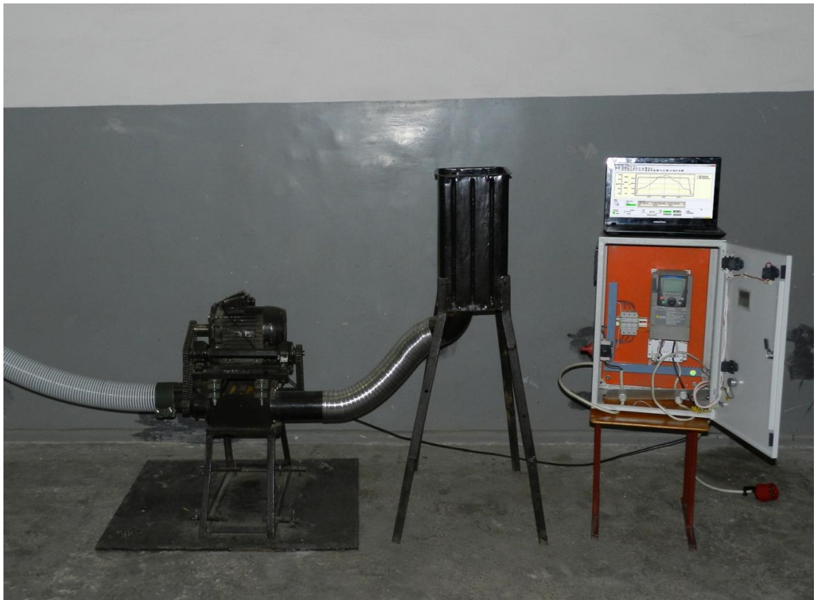
Рис.3.7. Загальний вигляд експериментальної установки та обладнання для регулювання частоти обертання ротора електродвигуна і отримання результатів
