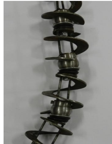
Рис.15. Конструктивна схема (а) та загальний вигляд шарнірно-секційного робочого органу (б)
