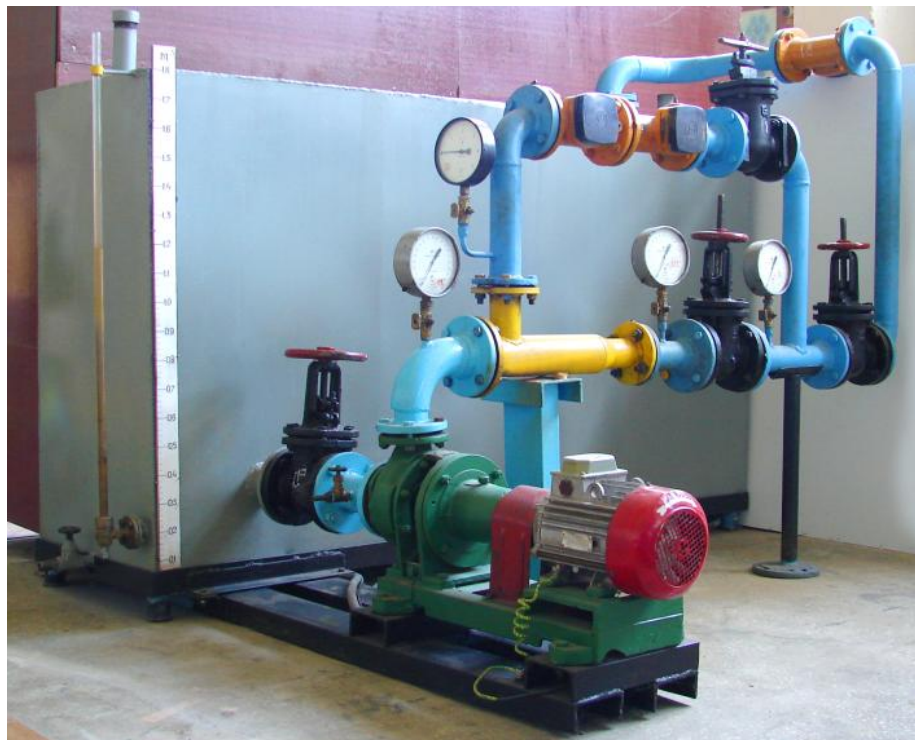
Рис. 3.4. Загальний вигляд стану для випробовування захисних втулок вала відцентрового насоса.
