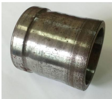
Рис. 1.2. Загальний вигляд зношеної захисної втулки вала відцентрового насоса.
