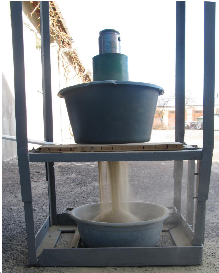
Рис. 3.10 Процес висипання сипкого матеріалу через гвинтові канали додаткового елемента забірною пристрою гвинтового конвеєра.
