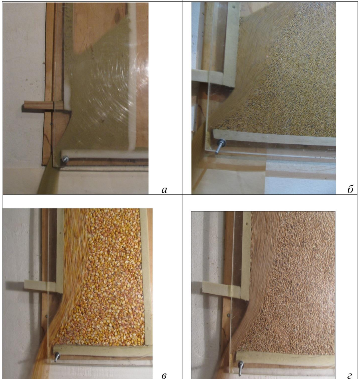
Рис. 3.2. Витікання сипкого матеріалу із плоскої моделі бункера: а- пісок, б – гірчиця, в – кукурудза, г – пшениця
