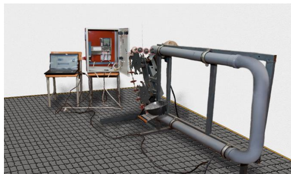
Рис. 6.14. Експериментальна установка трубчастого скребкового конвеєра переміщення сипкого середовища [282]
