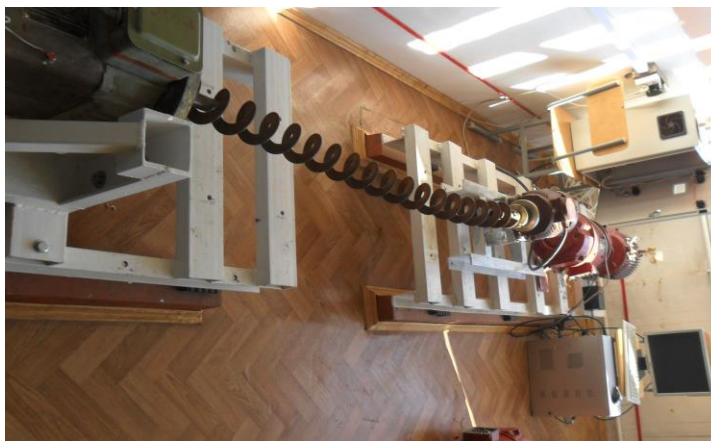
Рис. 6.13. Стенд для дослідження деформаційно-силових характеристик гвинтових спіралей: а) схема; б) загальний вигляд
