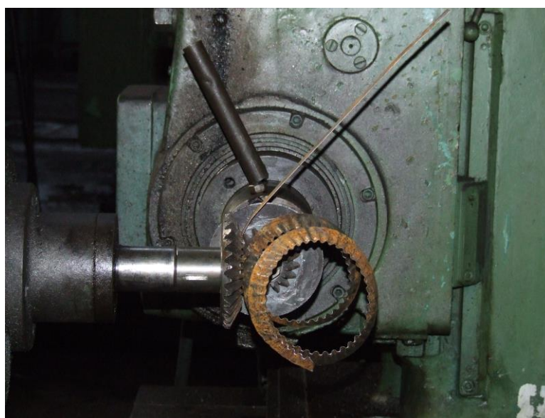
Рис. 6.32 Процес формоутворення ГГЗ парою неортогональних формувальних інструментів ( \alpha=35^\circ ) на обкатному верстаті
