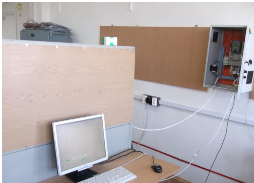
Рис. 6.1. Загальний вигляд автоматизованого електроприводу для дослідження механічних систем і персональним комп'ютером
