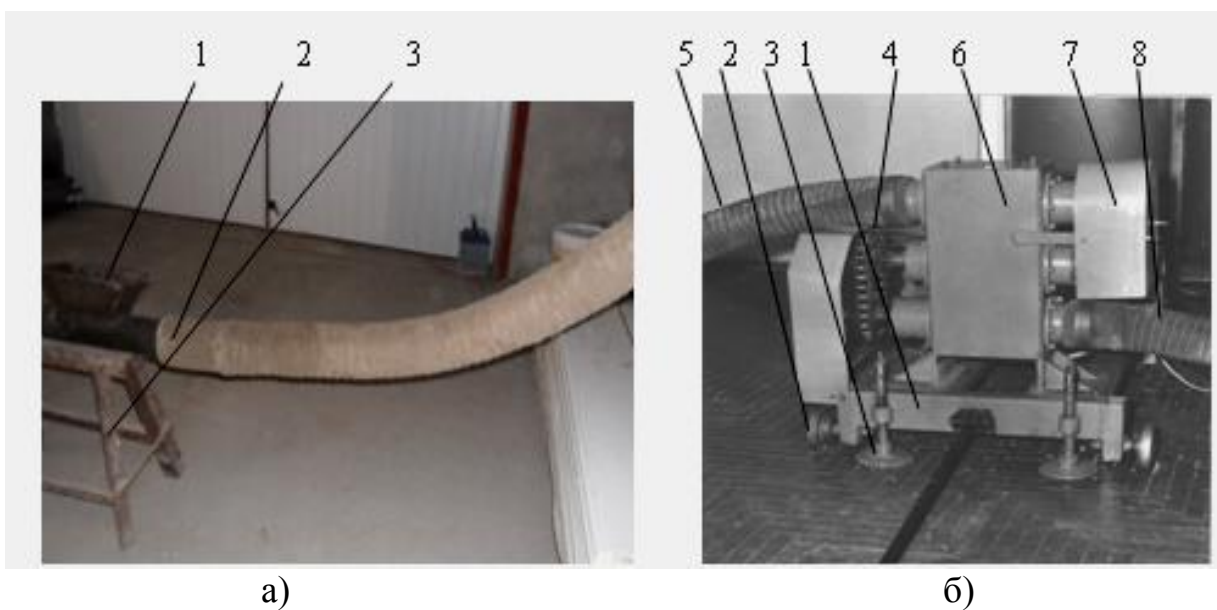
Рис. 6.7. Стенди для дослідження процесів транспортування сипких матеріалів гнучкими ГК: а) з вивантажувальною магістраллю; б) з завантажувальною і вивантажувальною магістралями та пересипним корпусом
