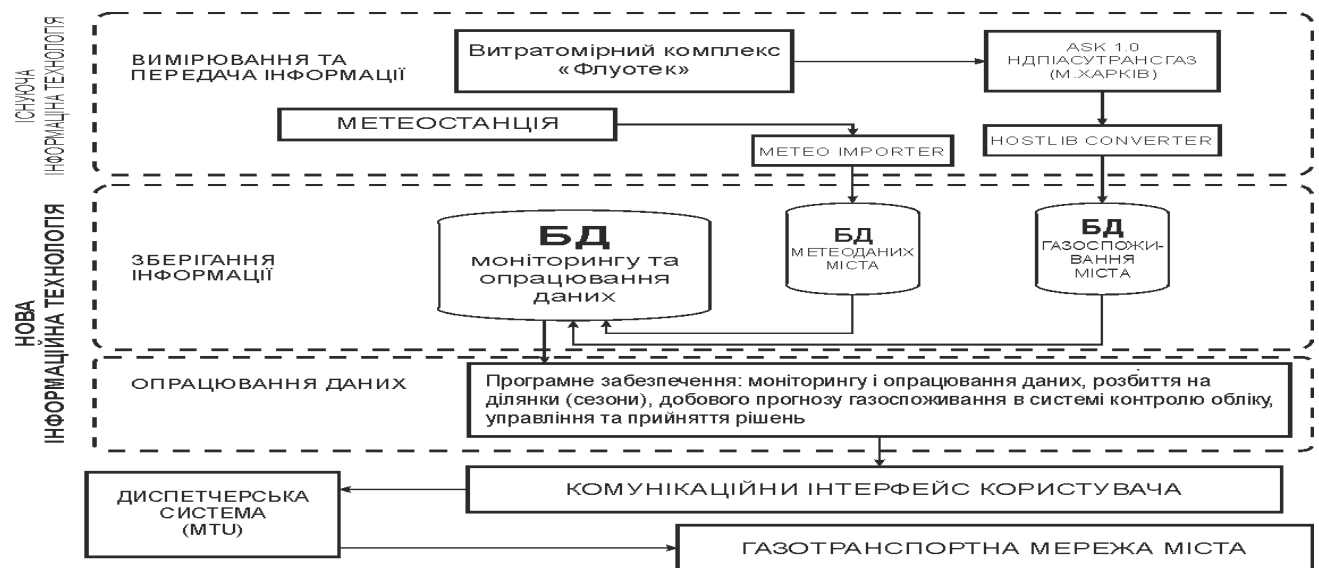
Рис. 4.10 – Структурна схема інформаційної технології «АСК-метео плюс»
