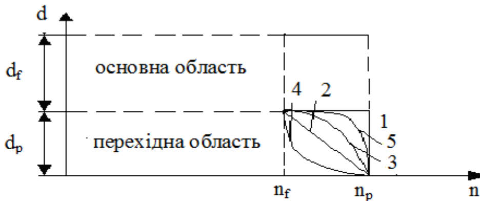
Рисунок 1 – Модель профілю показника заломлення частково неоднорідної плівки (розподіли показника заломлення: 1 – ступінчастий; 2 – лінійний; 3 – квадратичний; 4 – логарифмічний; 5 – експоненціальний)
