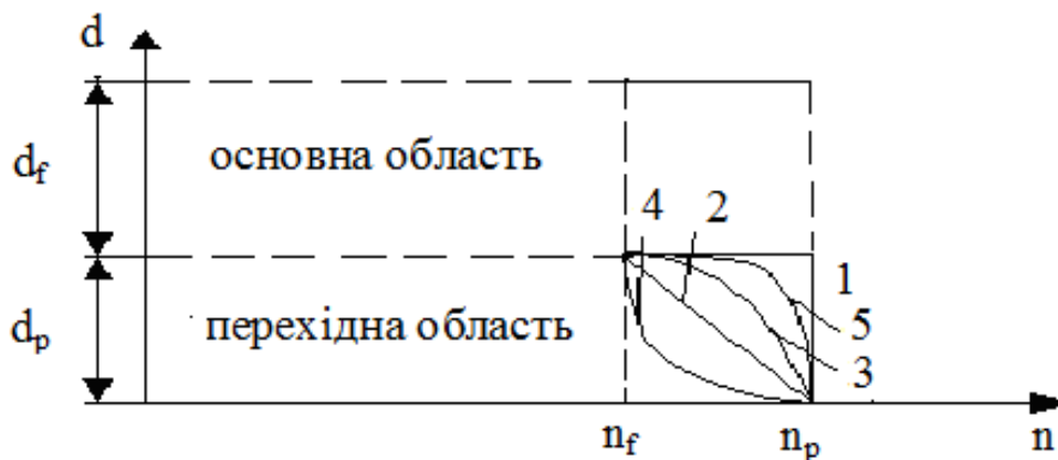
Рис. 3.1. Модель частково неоднорідної плівки (розподіли показника заломлення: 1 – ступінчастий; 2 – лінійний; 3 – квадратичний; 4 – логарифмічний; 5 – експоненціальний)
