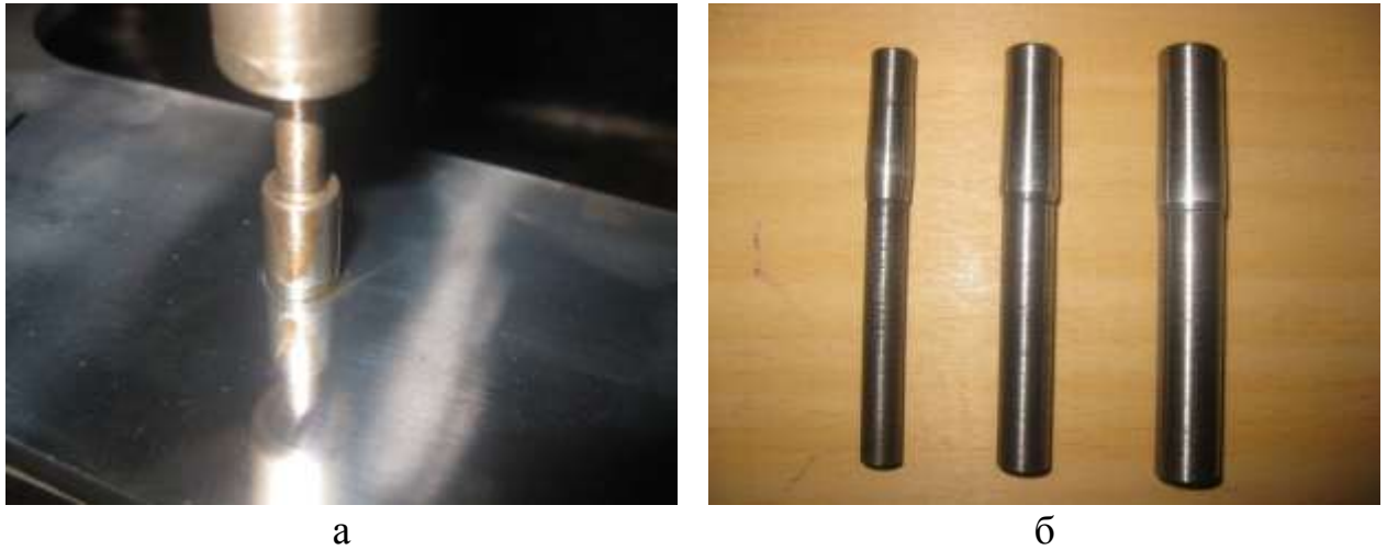
Рисунок 2.3 – Фото пресу PUE-100 з закріпленим дорном в процесі дорнування досліджуваного зразка (а), фото дорнів (б)
