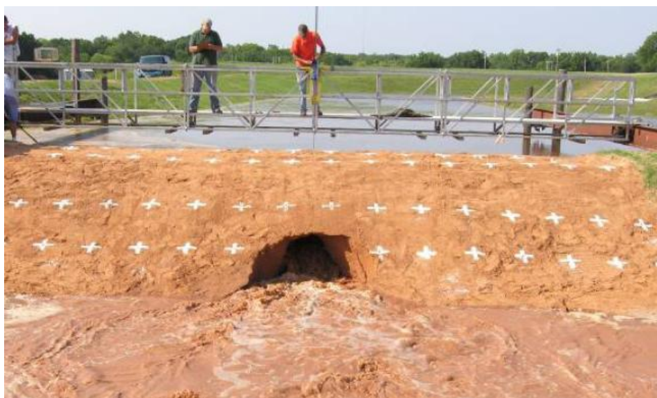
Рис. 1.13. Розмив тіла модельної ґрунтової греблі через зосереджений шлях фільтрації [400]
