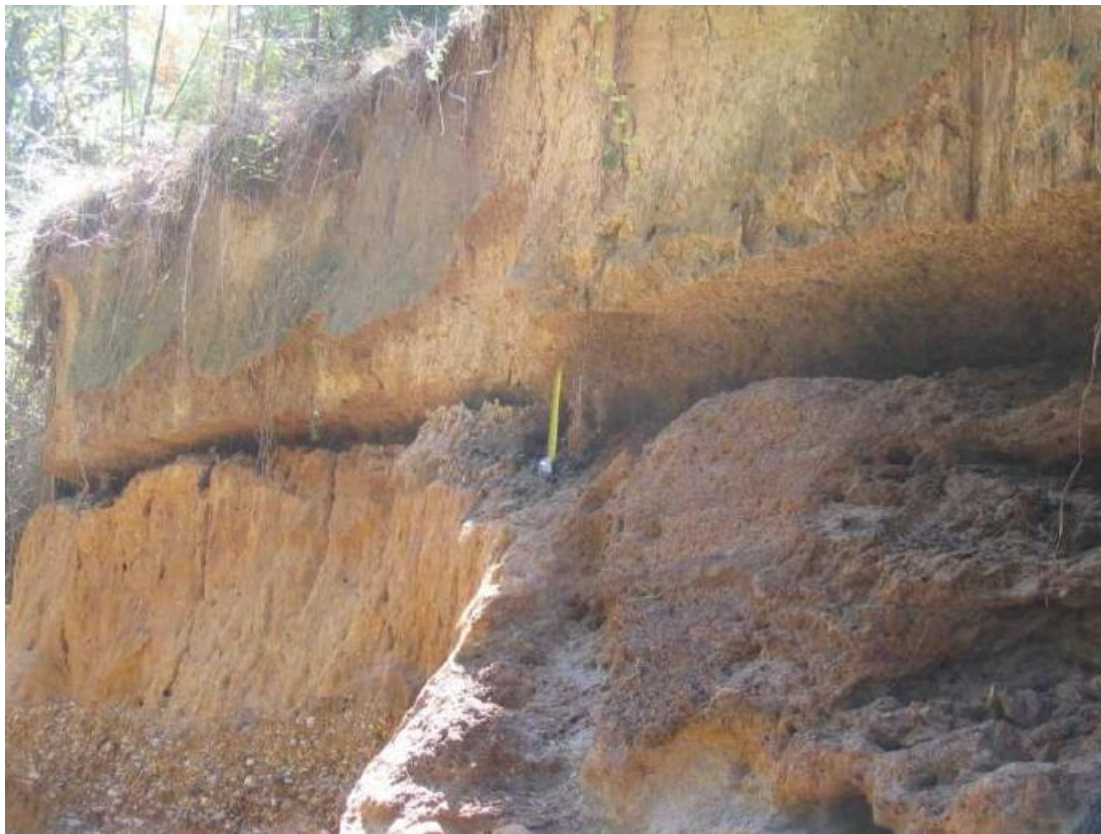
Рис. 1.8. Контактний розмив ґрунту (Міссісіпі, США)
