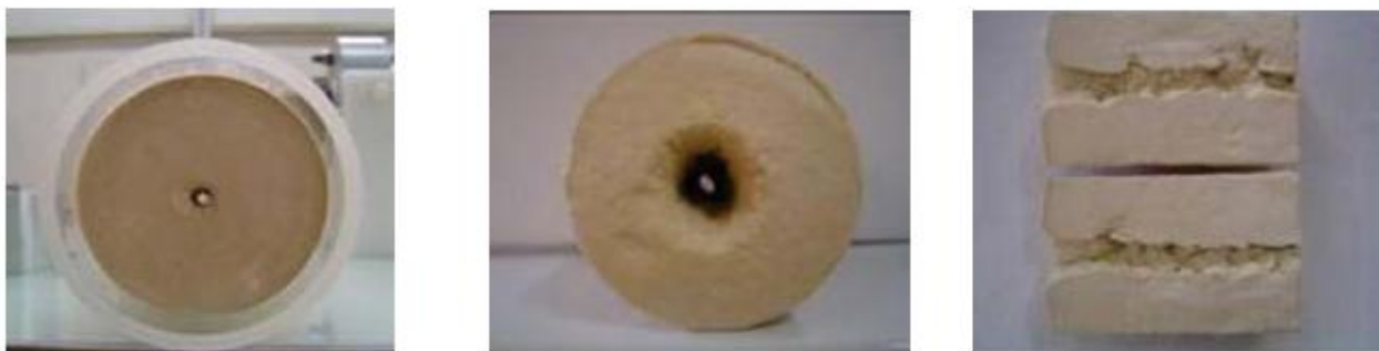
Рис. 1.12. Зразки експериментального дослідження каоліну на розмив через зосереджений шлях фільтрації
