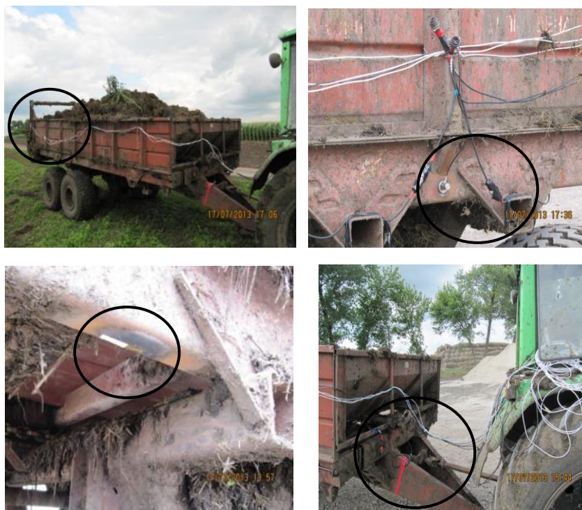
Рис. 10. Розміщення тензорезисторів при проведенні експлуатаційних польових досліджень НДС несучої системи причіпного розкидача ПРТ – 10
