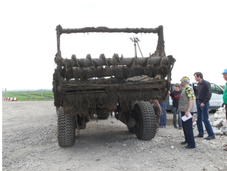
Рис. 6.20. Експлуатаційні дослідження НДС несучої рами причіпного розкидача твердих органічних добрив ПРТ - 10
