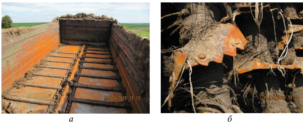
Рис. 2.10. Загальний вигляд розкидача добрив РТД-9 після двох років експлуатації: а) кузов; б) сегментний шнек.
