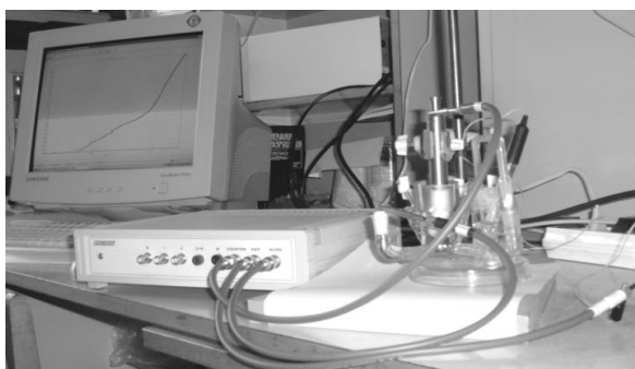
Рис. 2.2. Комплекс для проведення електрохімічних досліджень: потенціостат, трьохелектродна комірка, комп'ютер з програмою керування і обробки залежностей «потенціал – час», «струм – потенціал».
