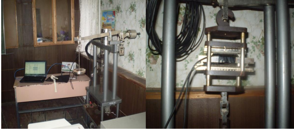
Рис. 6.6. Тарування тензорезисторів на універсальному пресі УП-8
