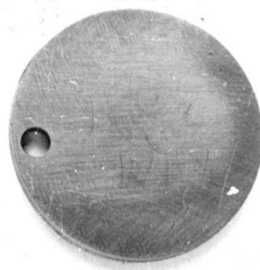
Рис.2.12. Загальний вигляд зразка сталі 20 після 24 діб експозиції в гноївці великої рогатої худоби
