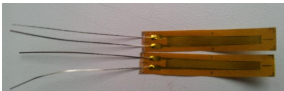
Рис.6.5. Тензометричний датчик опору одиночний прямокутний П1
