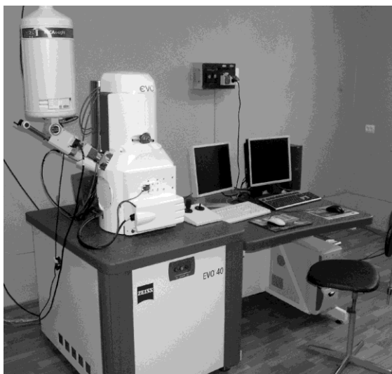
Рис. 3.14. Загальний вигляд електронного мікроскопа ZEISS EVO 40XVP з системою рентгенівського мікроаналізу INCA Energy
