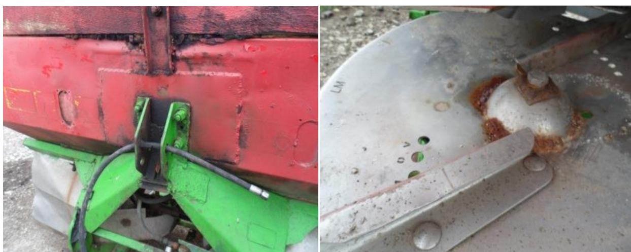
Рис.1.15. Руйнування металоконструкцій розкидача мінеральних добрив
