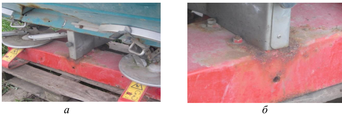
Рис. 2.3. Загальний вигляд стану лакофарбових покриттів (а) і корозійні пошкодження (б) розкидача мінеральних добрив після сезону експлуатації
