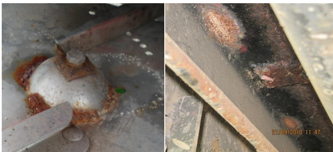
Рис. 7.1. Заварені корозійно – втомні пошкодження (тріщини) елементів розкидачів добрив: а- мінеральних; б- органічних.
