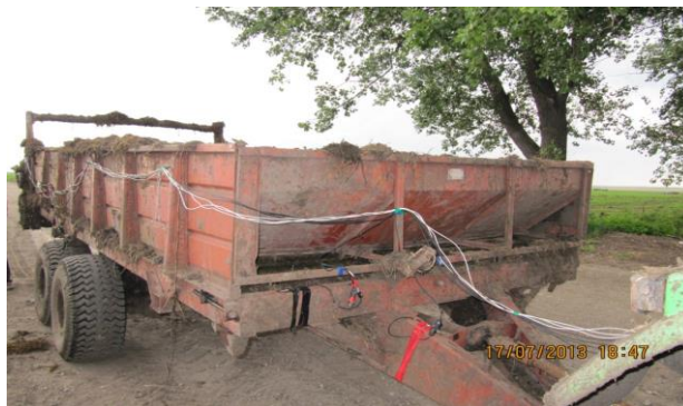
Рис. 6.22. Розташування тензорезисторів на поперечині рами
