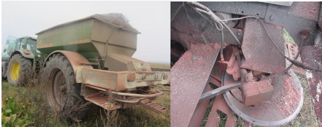
Рис. 2.1. Загальний вигляд розкидача мінеральних добрив і його робочих органів після одного сезону експлуатації
