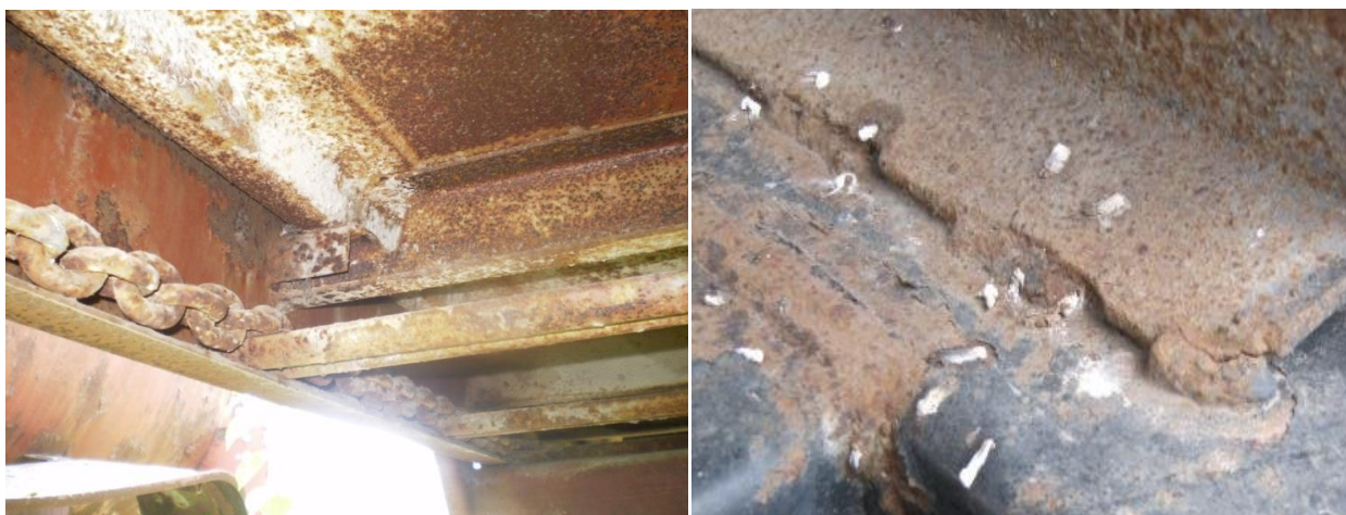
Рис. 1.14. Корозійно - втомні тріщини несучої системи розкидача твердих органічних добрив
