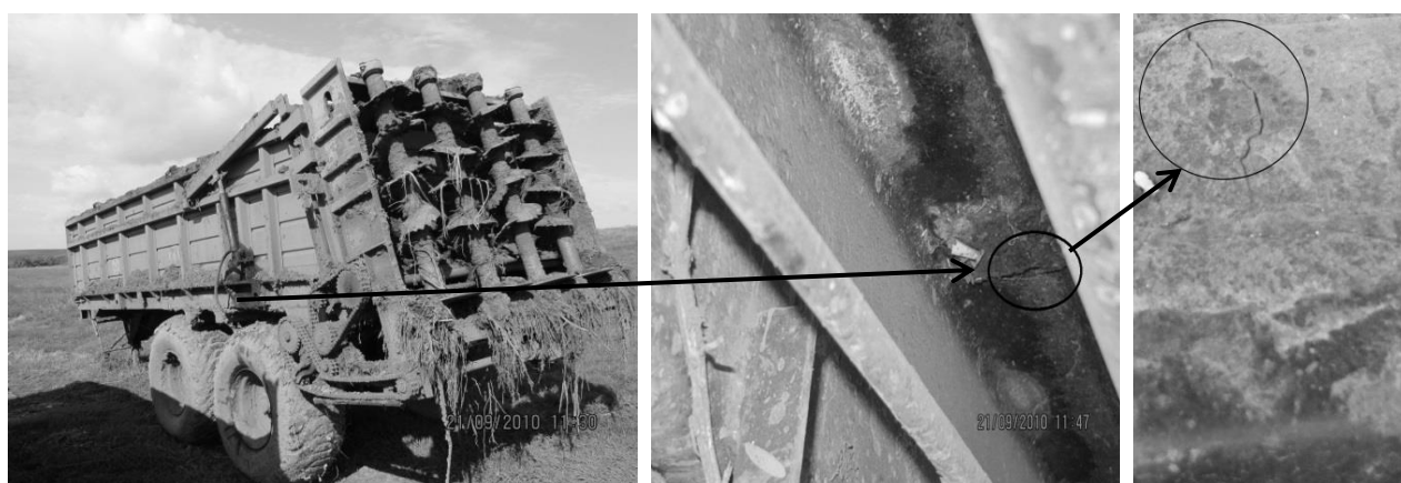
Рис. 1.12. Загальний вигляд розкидача твердих органічних добрив РТД -9 після двох сезонів експлуатації
