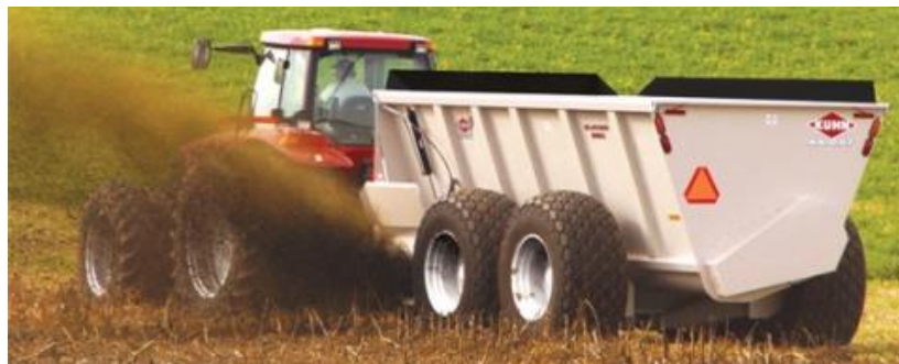
Рис.1.4. Розкидач KUHN з системою PROTWIN SLINGER
