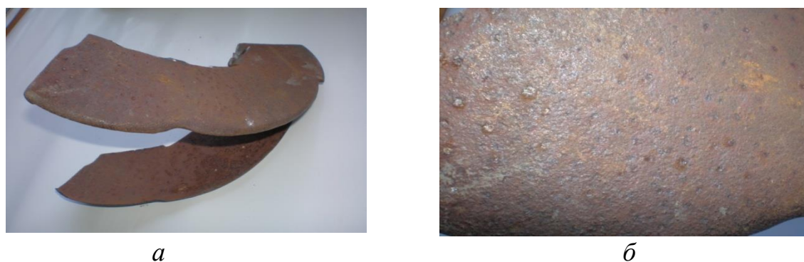
Рис. 2.4. Загальний вигляд витка шнека (а) і корозійні пошкодження (б) на його поверхні після 5 років експлуатації.
