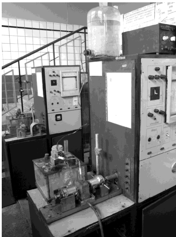
Рис. 3.7. Загальний вигляд установки для досліджень зразків в умовах корозійної втоми
