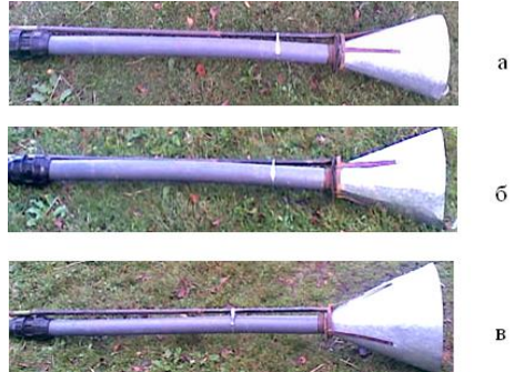
Рис. 15. Фото пристрою для добування сапропелю та його комплектування піднімальним трубопроводом діаметром d=0,067\text{м} та змішувачем із кутом нахилу твірної: а) \alpha_k=15^\circ ; б) \alpha_k=20^\circ ; в) \alpha_k=25^\circ
