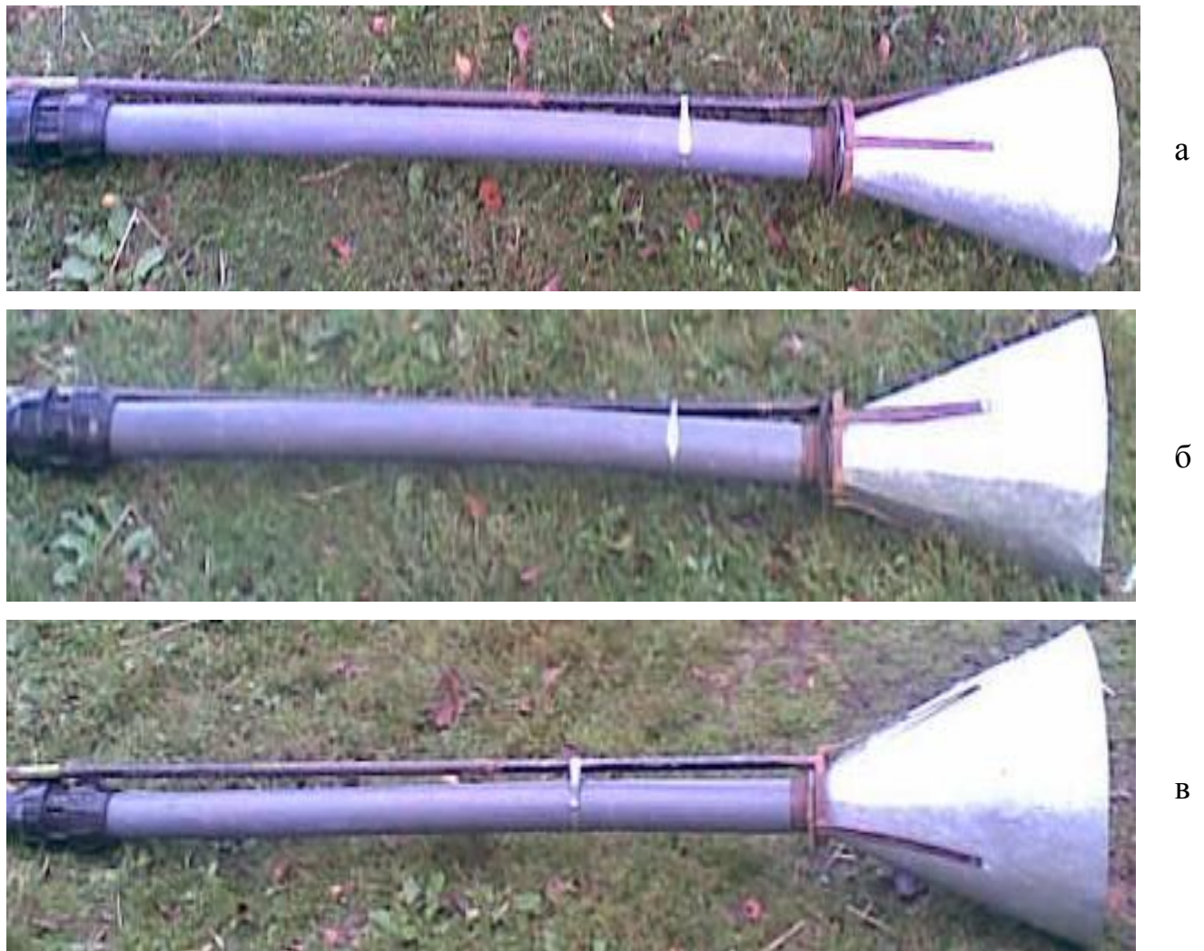
Рис. 5.2. Фото пневматичного забірною пристрою експериментальної установки за його комплектування піднімальним трубопроводом діаметром d=0,067 м та конусоподібним корпусом із кутом нахилу твірної: а – \alpha = 15^{\circ} ; б – \alpha = 20^{\circ} ; в – \alpha = 25^{\circ}
