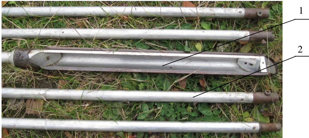
Рис. 3.2. Фото сапропелерозвідувального бура: 1 – пробовідбірний човник; 2 – подовжувальні штанги з фіксаторами
