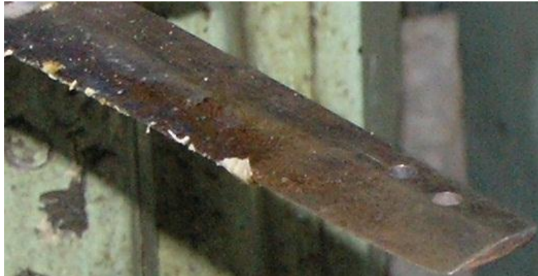
Рис. 3.14. Характер тертя в зоні різання ножем головок коренеплодів цукрових буряків
