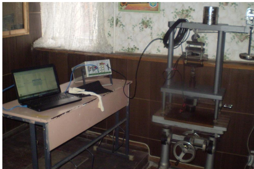
Рис. 3.9. Тарування тензорезисторів на універсальному пресі УП-8
