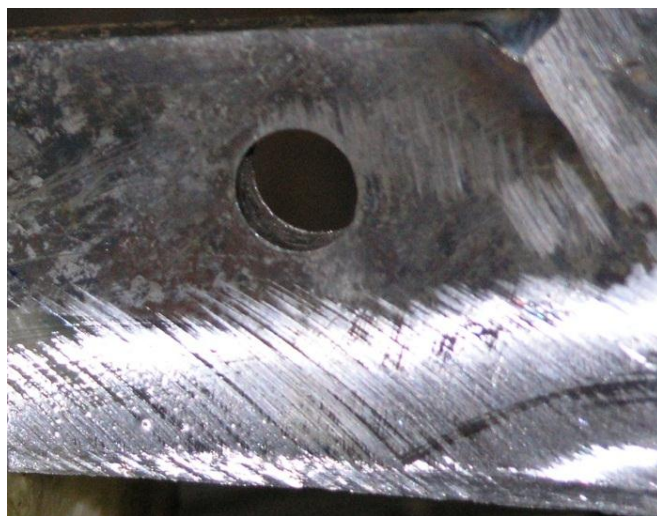
Рис. 4.10. Ріжуча кромка плоского ножа дообрізувача гички
