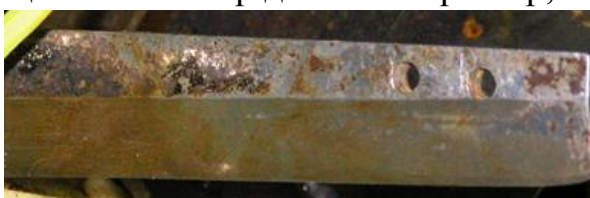
Рис. 12. Корозійні пошкодження плоских ножів дообрізувачів гички
