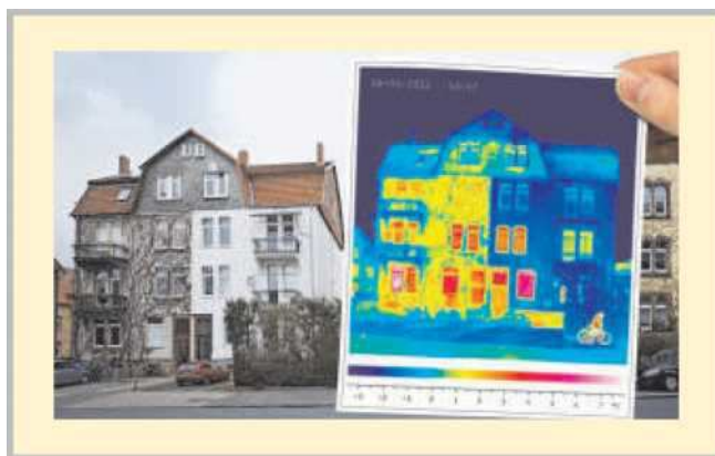
Рисунок 2.1 – Фото тепловізором утепленого будинку [30]
