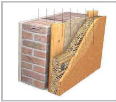
Рис. 3.5 – Приклад утеплення стіни панелями з очерету
