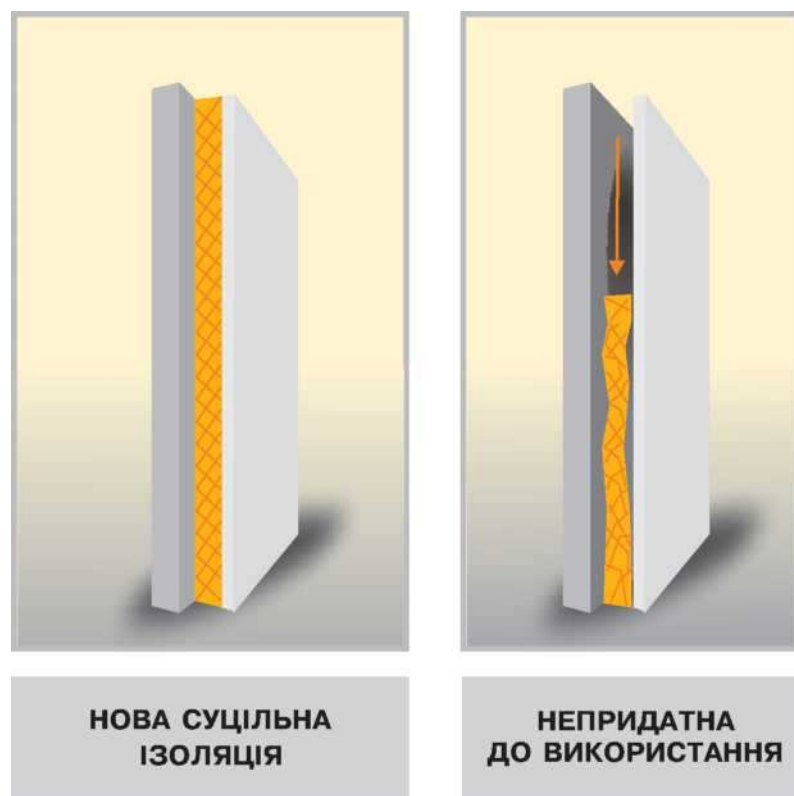
Рисунок 4.2 – просідання ізоляції з часом
