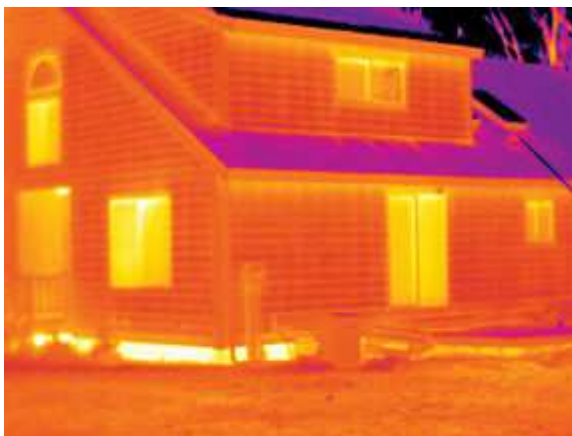
Рисунок 2.2 – Знімок тепловізором будинку з великими втратами тепла [31]
