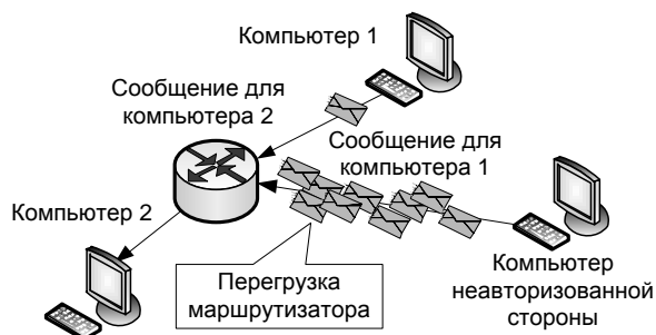
Рис. 9.23. Реализация перегрузочного НСД
