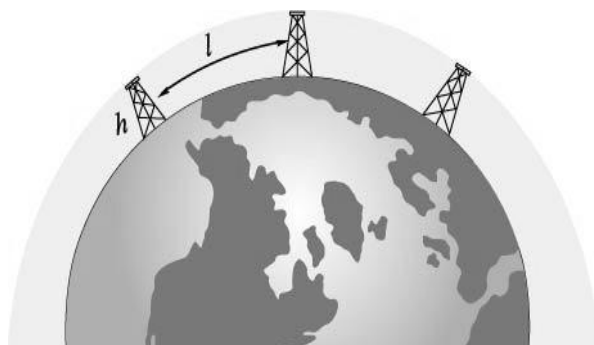
Рис. 5.5. Радиорелейный канал связи
