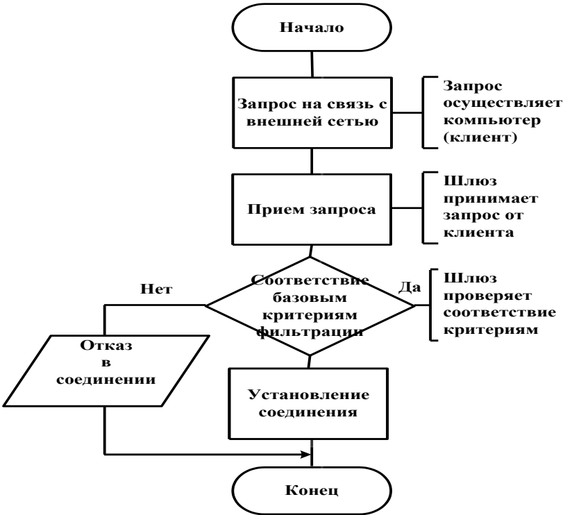
Рис. 9.39. Алгоритм определения допустимости запроса на сеанс связи
