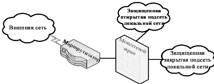
Рис. 9.46. Схема с распределенной защитой закрытой и открытой подсети на основе одного брандмауэра с тремя сетевыми интерфейсами
