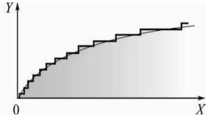
Рис. 4.60. Квантование с логарифмической характеристикой
