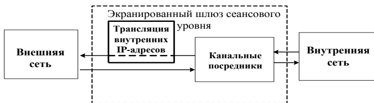
Рис. 9.41. Схема функционирования шлюза сеансового уровня
