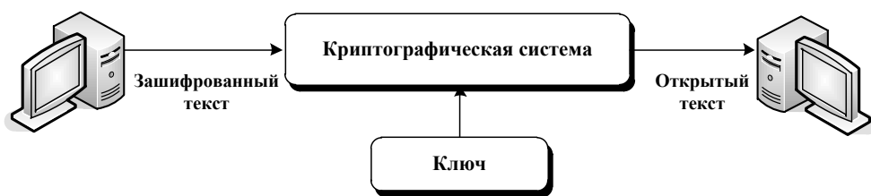
Рис. 8.2. Структурная схема процесса расшифровывания
