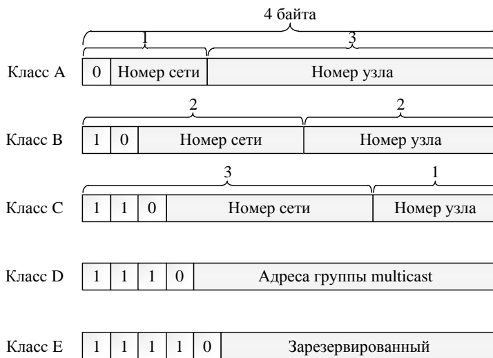
Рис. 6.6. Классы IP адресов
