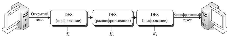
Рис. 8.16.Схема тройного DES
