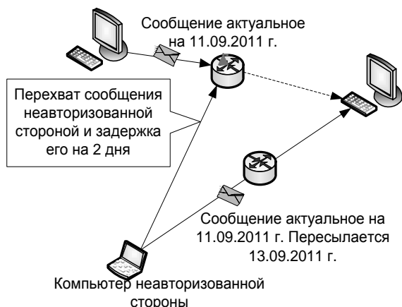
Рис. 9.25. Пример задерживающего НСД
