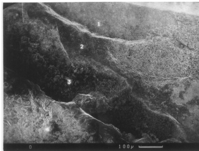
Рисунок 5. Злам окалини на сплаві (Ti, Nb)C-Ni-Cr-Al з 24 мас.% Ni-Cr. Температура окислення 1393 К, тривалість шість годин.
