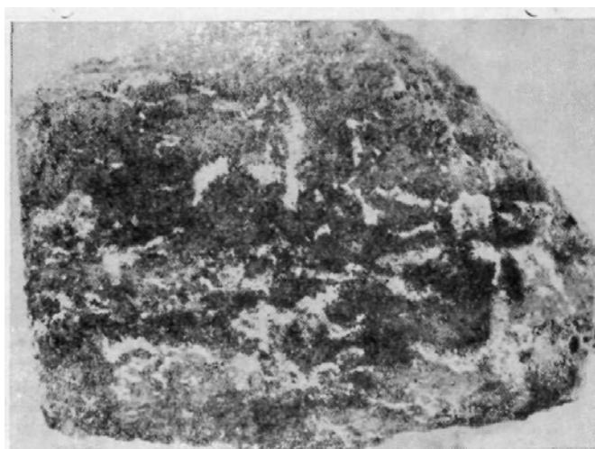
Рис.1.3. Характерний вигляд загіпсованого ґрунту
