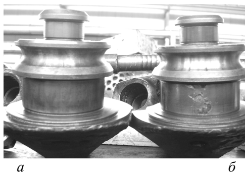
Рисунок 2 – Загальний вигляд цапф лап тришаршкових бурових доліт 244,5 ОК-ПГВ-Д26.040 після 20 год відпрацювання на стенді:
