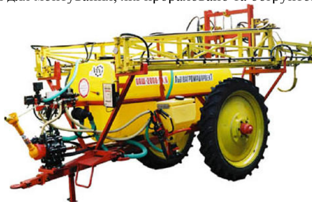
Рис. 1. Обприскувач ОПШ-2000-2 з комп'ютерною системою управління технологічним процесом
