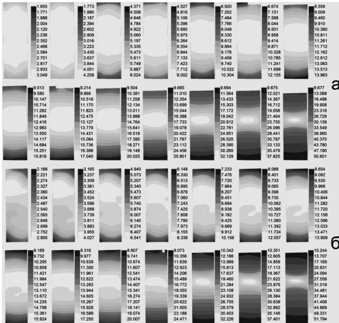
Рис. 8. Порівняння процесу статичного деформування, для обох процесів встановлено однакову базу – базу нульового кадру після ДНП: а – поля деформацій при статичному деформуванні; б – поля деформацій при статичному деформуванні після ДНП
