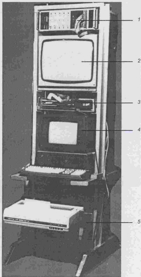
Рис. 4. Зовнішній вигляд підсистеми оперативної обробки та візуалізації оперативної інформації: 1 — БОЦ; 2 — КГТ; 3 — СП; 4 — ДВК; 5 — ВЗУ
