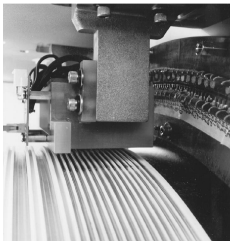
Рис. 10.8 Фотографія ковзних, самозмащувальних кільцевих контактів в гантрі для передачі потужних і сигнальних електричних напруг і струмів
