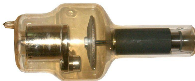
Рис. 10.7 Джерело X-променів (х-променева трубка)
