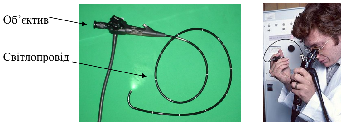
Рис. 1.1 Гнучкий ендоскоп. Світлопровід вводиться у внутрішні порожнини організму через природні шляхи (в шлунок — через рот, в легені — через гортань тощо), або через прокол чи хірургічний доступ
