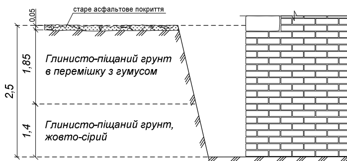
Рис. 2.25. Розріз шурфа
