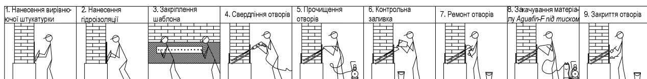
Рис. 3.1. Схема технологічної послідовності виконання горизонтальної гідроізоляції
