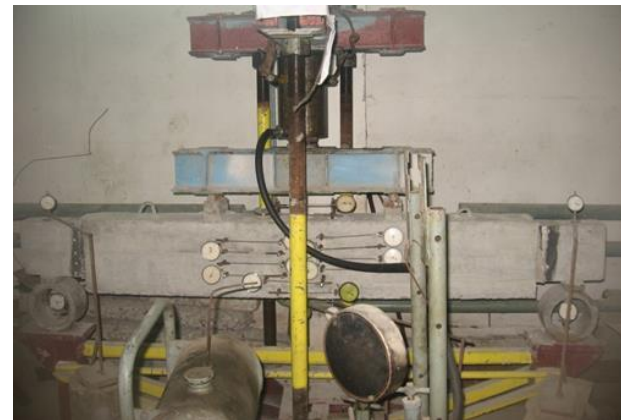
Схема розташування приладів при навантаженні балки до певного проектного рівня
