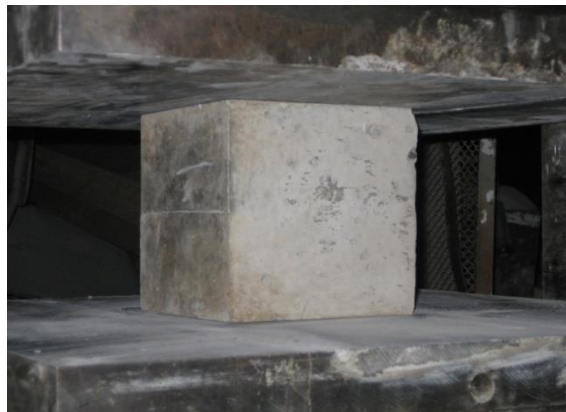
Випробування кубиків на міцність
