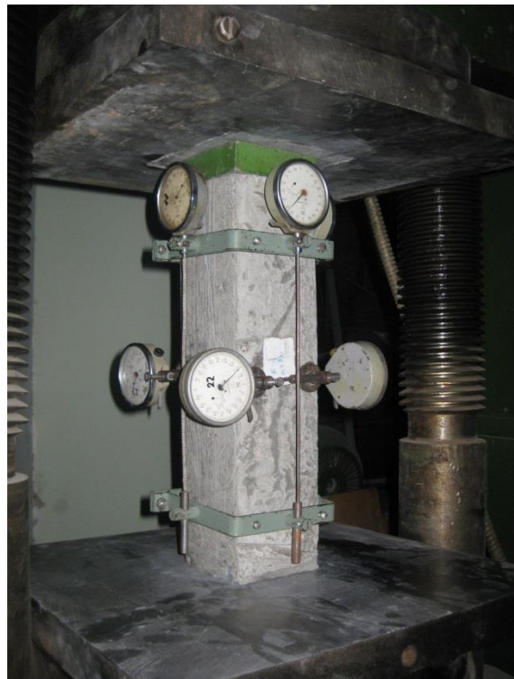
Випробування призм на міцність
