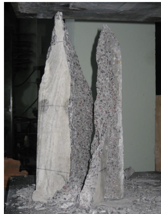
Випробування призм на міцність
