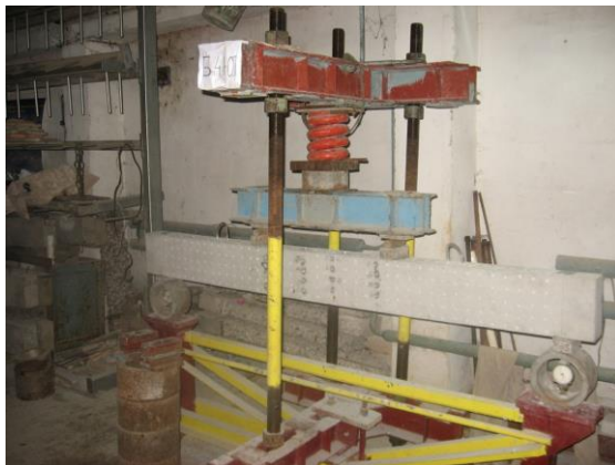
Схема розташування приладів при навантаженні балки до певного проектного рівня
