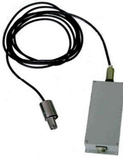
Рисунок 1.5 - Оптико-поляризаційний тензOMETричний датчик «ТД-16оп»
