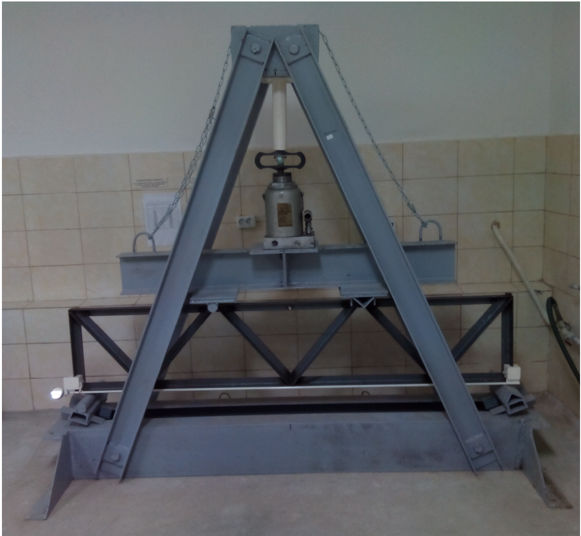
Рисунок 2.8 - Зварна ферма на випробувальному стенді перед навантаженням
