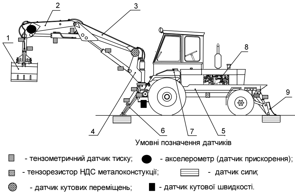
Рис. 8. Схема досліджень динамічних показників грейферного навантажувача ПЕА-1А «Карпатець»:
